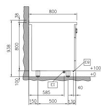
Electrical inlet (power) Equipotential screw
